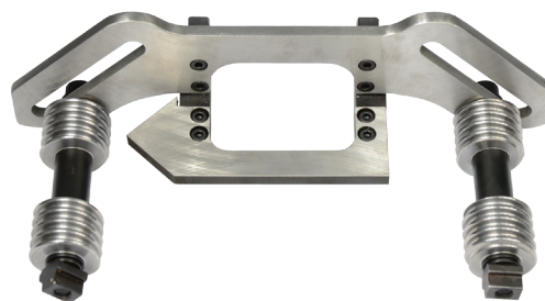
Štandardná univerzálna antikorózna vodiaca doska sa používa na ukosovanie hrán plechov aj rúr s Ø 150-300mm (6-12")
